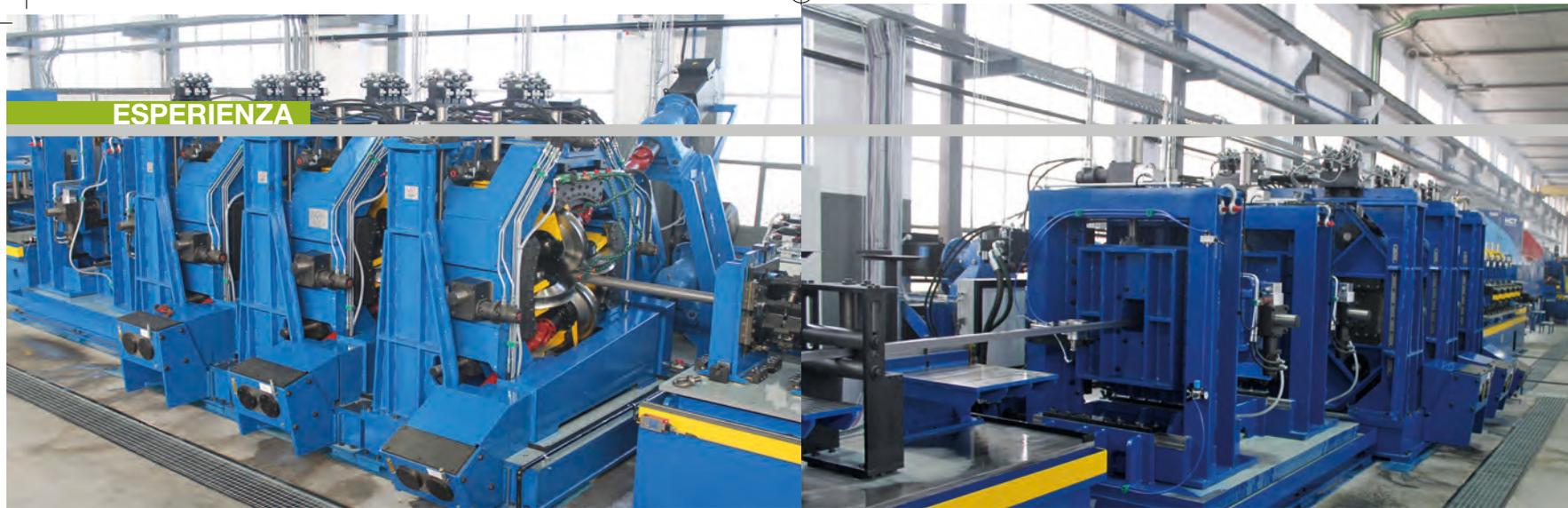
Lato ingresso e lato uscita teste di turco universali. / Universal Driven Turk's Heads entry and exit side installed in the fully automatic tube mill.
