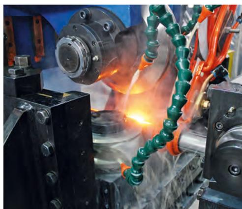
Sezione di saldatura.
