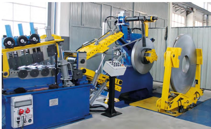
Lato ingresso della linea del laminatoio di tubi Olimpia80 Tube Mills.
