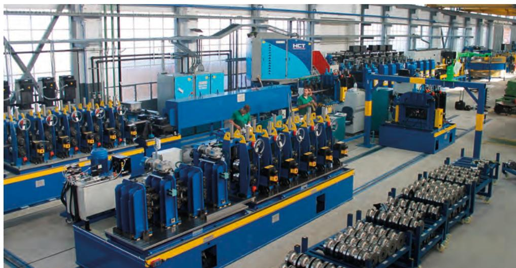
Vista generale con i bancali per il cambio rapido. / General view with the Cassette for Quick roll Change on rails.
