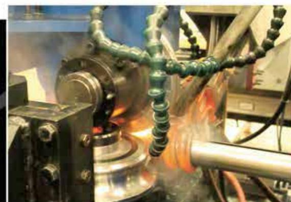
Testa di saldatura a 5 rulli per produzione di tubi di grandi diametri.
