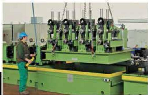
Movimentazione dei gruppi di formatura e di calibratura tramite sollevamento.
