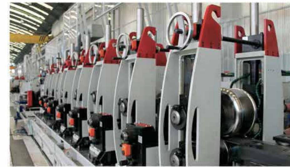
Linea completa per la produzione di tubi in acciaio con diametri da 35 mm a 130 mm.
