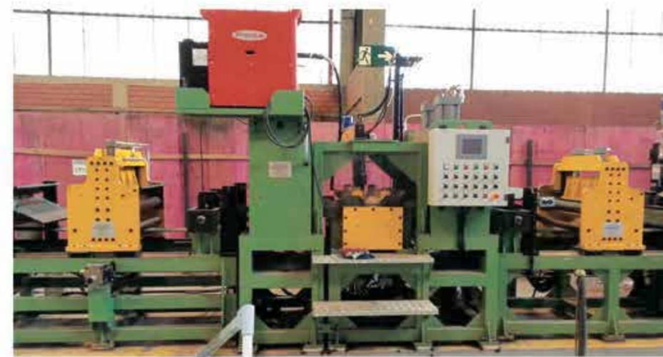
Banco giuntanastri automatico con doppia cesoia, per linea da 8", completo di sistema automatico di fresatura dell'eccesso del cordone di saldatura.
