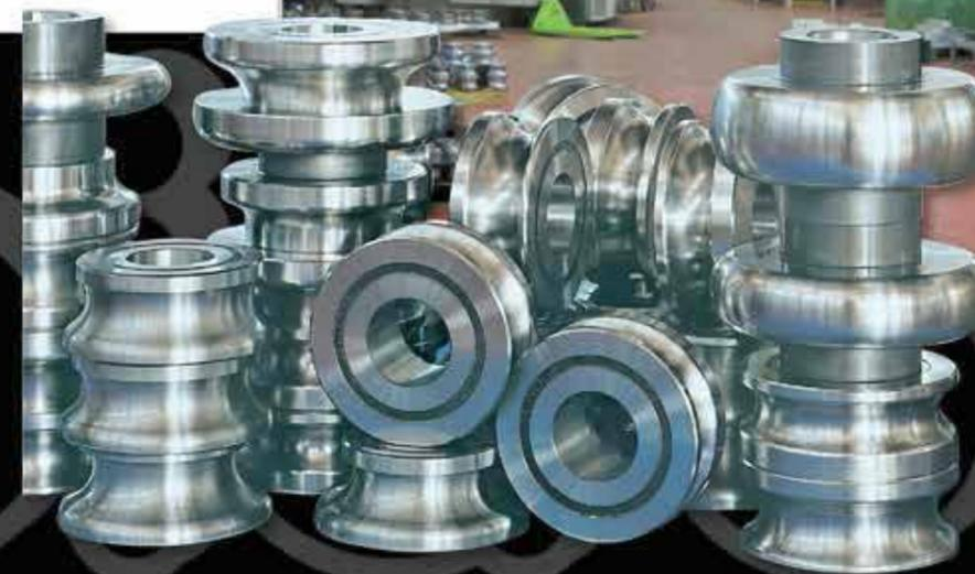
Rulli per la produzione di tubi tondi realizzati in acciaio K110, 62 HRc.
