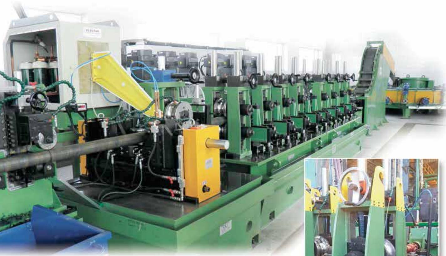
Linea per la produzione di tubi in acciaio da 25 mm a 88.9 mm di diametro completa di sistema di cambio rapido su bancali mobili.
