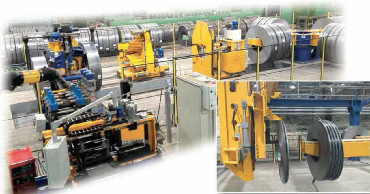
Sistema automatico di carico nastri, con giostra a 4 bracci da 120 t tot., carro di carico automatico ed aspo doppio da 9 t+9 t.
