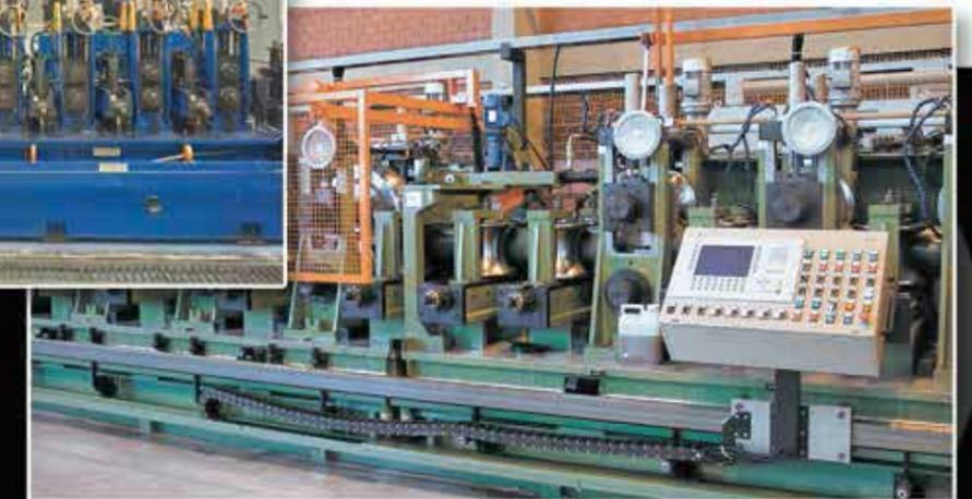
Linea completa per la produzione di tubi in acciaio con diametri da 60 mm a 220 mm.
