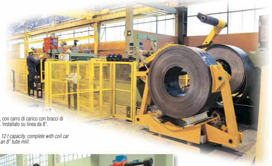
Aspo singolo da 12 t, con carro di carico con bracci di contenimento laterali. Installato su linea da 8".
