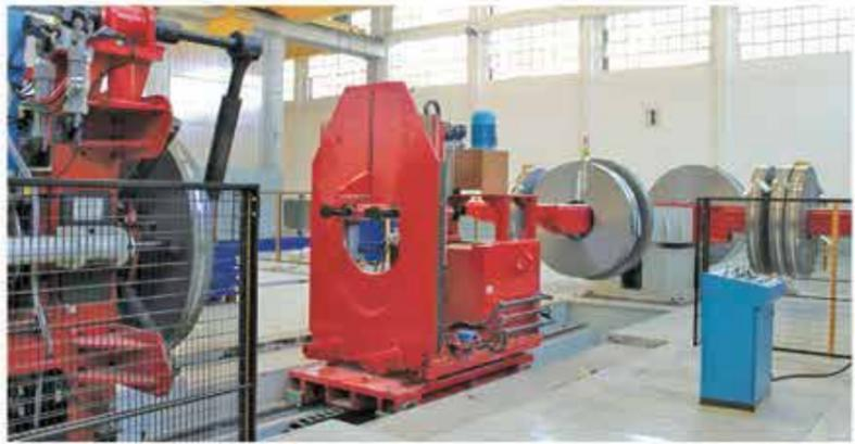
Sistema automatico di carico nastri, con giostra a 4 bracci da 120 t tot., carro di carico automatico ed aspo doppio da 9+9 t.
