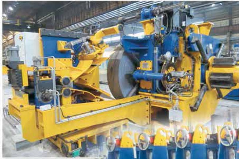
Linea completa per la produzione di tubi in acciaio saldati in alta frequenza, con diametri da 40 a 133 mm e spessore max 6 mm.
