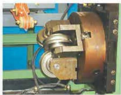
Testa di saldatura a 3 rulli.
