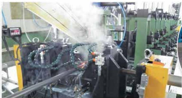
Testa di saldatura a 2 rulli completa di cella di carico.
