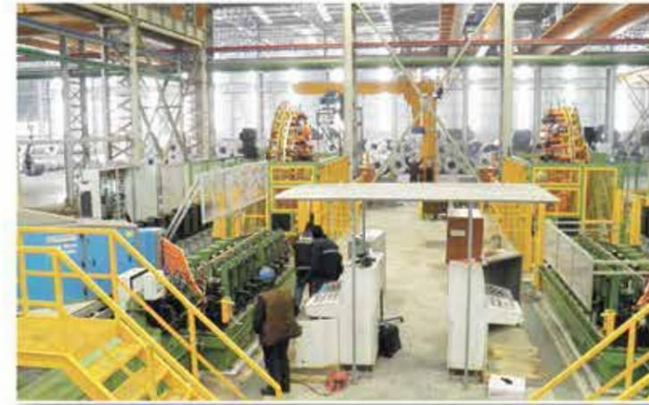
Linea completa per la produzione di tubi in acciaio ad alta precisione, da 10 mm a 42.4 mm di diametro.
