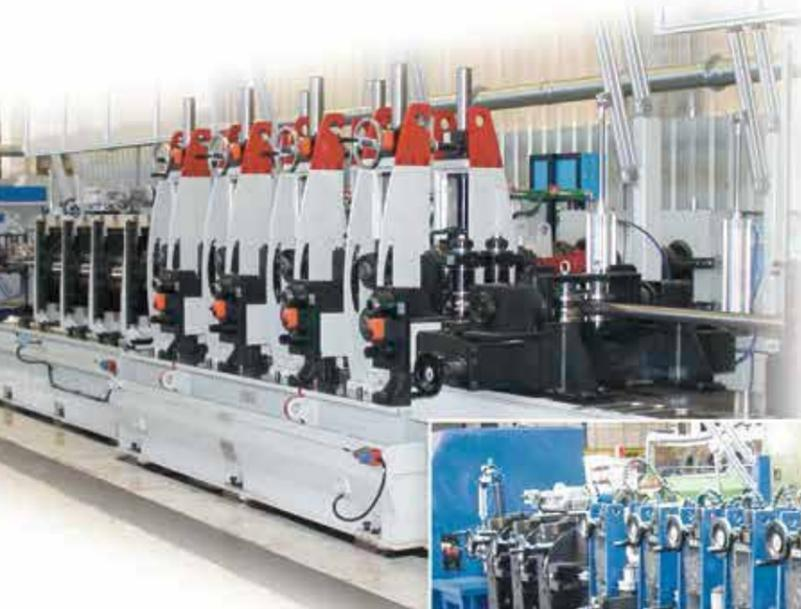
Gruppo di calibratura e riduzione del tubo con 8 teste motorizzate.
