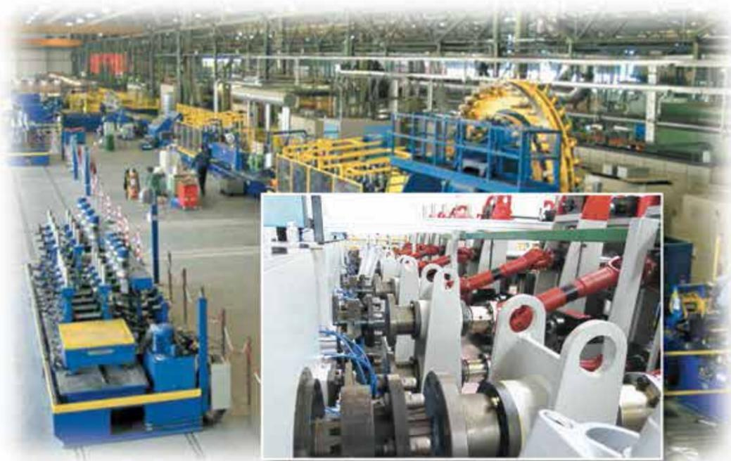
Bancali intercambiabili di formatura e calibratura montati su slitte di scorrimento.
