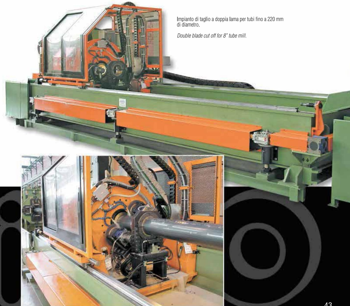
Impianto di taglio a doppia lama per tubi fino a 220 mm di diametro.
