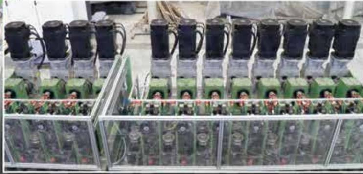
**Teste motorizzate di calibratura e teste di turco** per la produzione di diversi profili.
