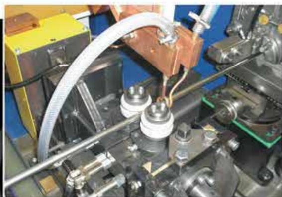
Testa di saldatura con rulli in ceramica. Permettono una riduzione del consumo del rullo e una ottimizzazione nel consumo di corrente di saldatura.
