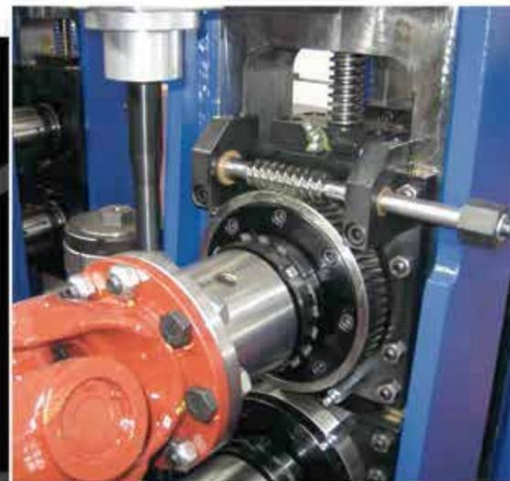
Olimpia 80 offre la possibilità di scelta tra una **MOTORIZZAZIONE STANDARD TRADIZIONALE**, composta da due motori nel gruppo di formatura e un motore nel gruppo di calibratura, oppure una **MOTORIZZAZIONE INDIVIDUALE** con un singolo motore per ogni testa motorizzata sia nel gruppo di formatura che nel gruppo di calibratura, permettendo così un maggiore controllo della lamiera ad alte velocità.
