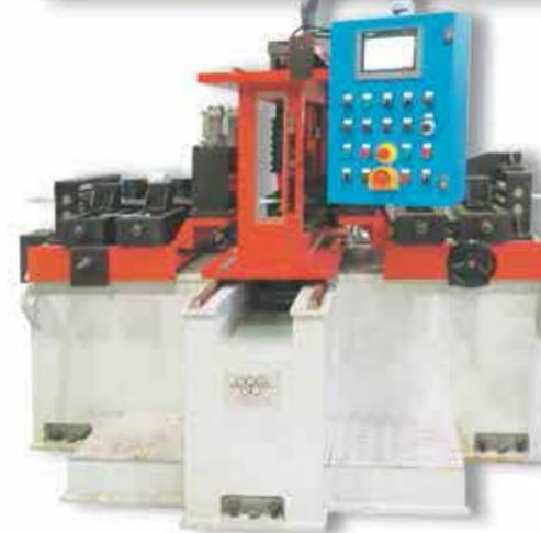
Giuntanastri automatico completo di sistema automatico di fresatura dell'eccesso del cordone di saldatura.
