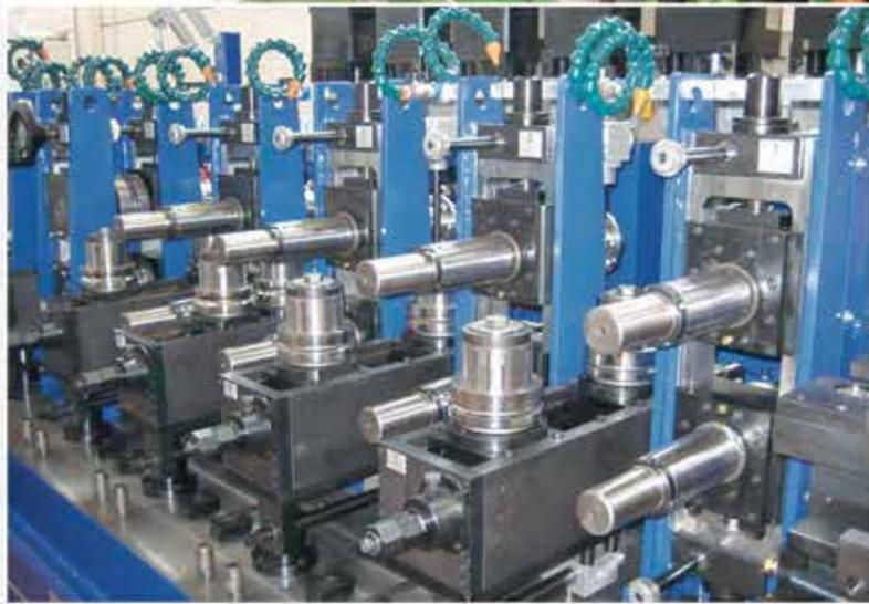
Teste di formatura ad alta precisione con accoppiamento rullo-albero tramite espansione meccanica dell'albero, che garantisce estrema esattezza sul diametro del tubo.
