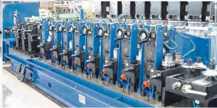
Sistema di calibratura ad alta precisione con accoppiamento rullo-albero tramite espansione meccanica dell'albero, che garantisce estrema esattezza del diametro del tubo. L'aumento del numero di teste di calibratura consente una riduzione del diametro finale del tubo.
