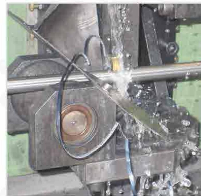
**SCORDONATORE AD UTENSILI PER TUBI SALDATI IN ALTA FREQUENZA**
