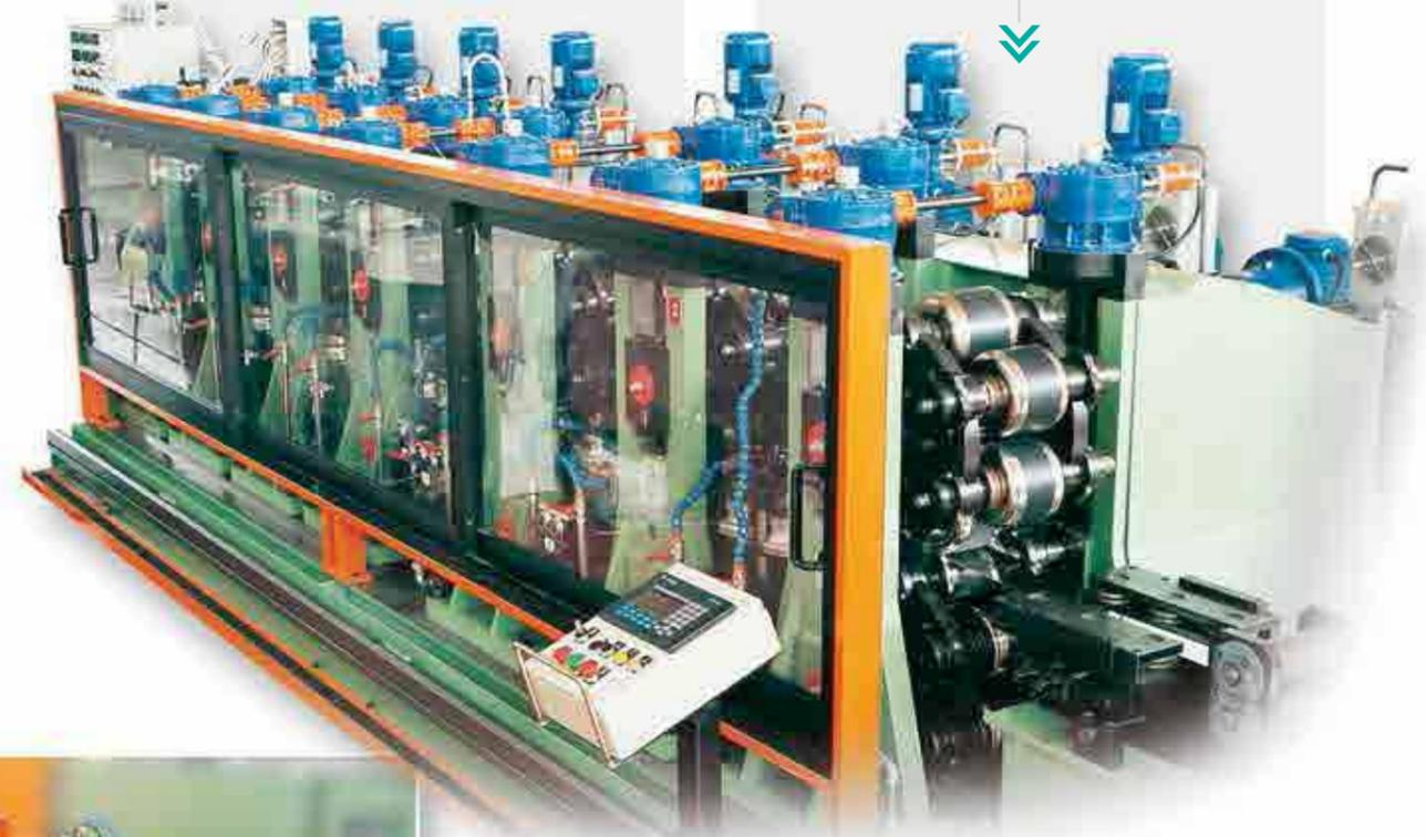
Motorizzazione singola delle teste.
