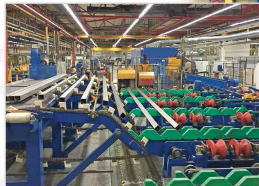
**LINEA DI PRODUZIONE DI TUBI FLESSIBILI SALDATI E CORRUGATI AD ONDE PARALLELE**
