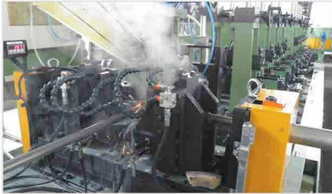
La **TESTA DI SALDATURA** progettata e realizzata da Olimpia 80 garantisce un assoluto controllo dei lembi, permettendo alte velocità di produzione e ottime qualità di saldatura. La testa è completa di chiusura autocentrante tramite martinetto, indicatore meccanico di posizionamento dei rulli e **cella di carico** per la rilevazione della pressione dei rulli sui lembi del tubo.
