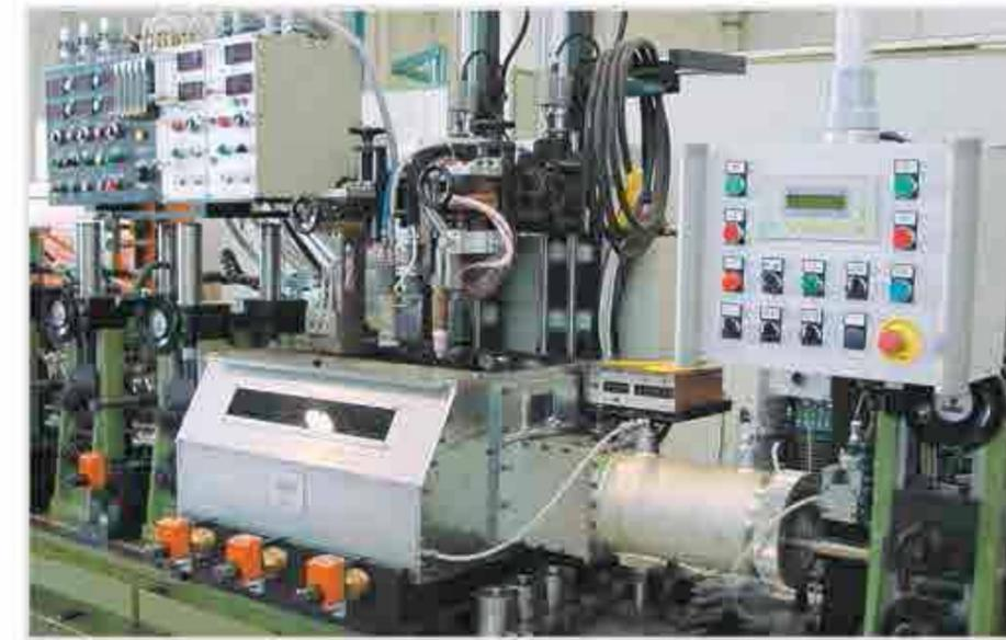
Box di saldatura con impianto Tricathodo e Plasma.
