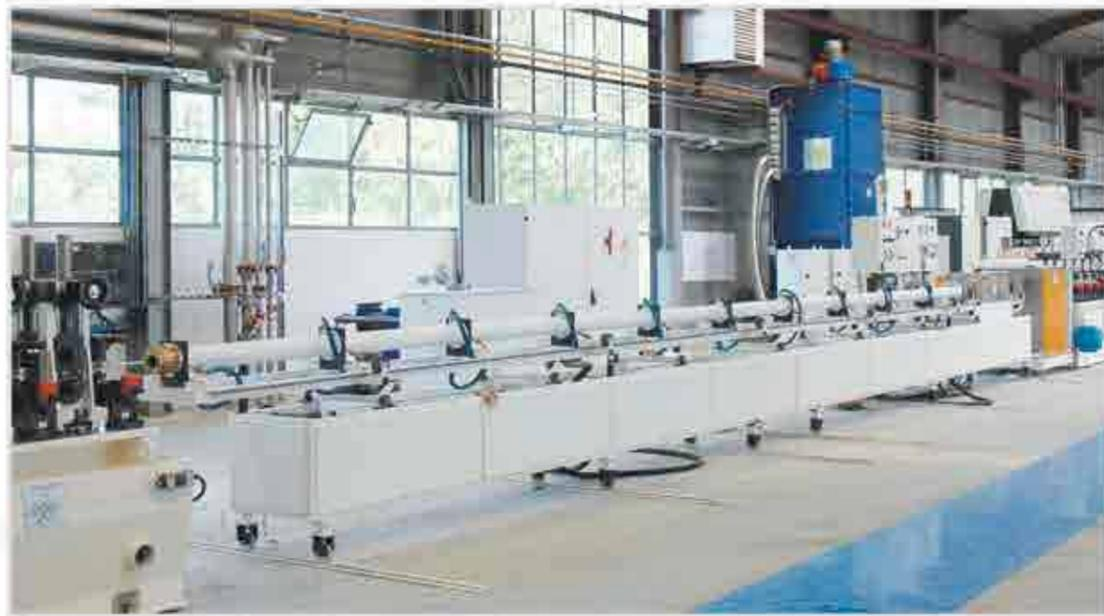
Olimpia 80 realizza **IMPIANTI DI RICOTTURA IN BIANCO IN LINEA** adatti alle più elevate velocità di produzione delle linee laser. L'azienda fornisce sistemi completi, per tubi da 6 mm a 114 mm di diametro, che comprendono oltre all'impianto di ricottura anche l'unità di lavaggio del tubo ed il pinch roll di traino.
