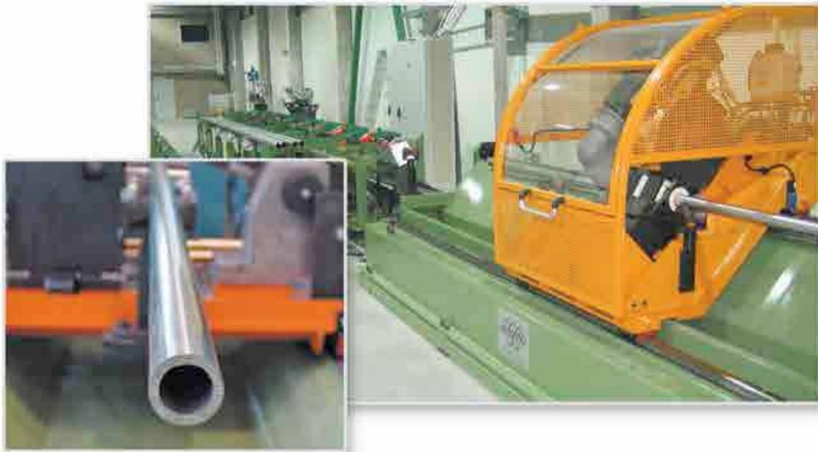
Per il taglio in lunghezza del tubo Olimpia 80 offre diversi modelli di **IMPIANTI DI TAGLIO** operanti con disco meccanico oppure con nastro. All'occorrenza il taglio può essere accompagnato da un **IMPIANTO DI SBAVATURA AUTOMATICA** delle estremità del tubo, posizionato in linea.
