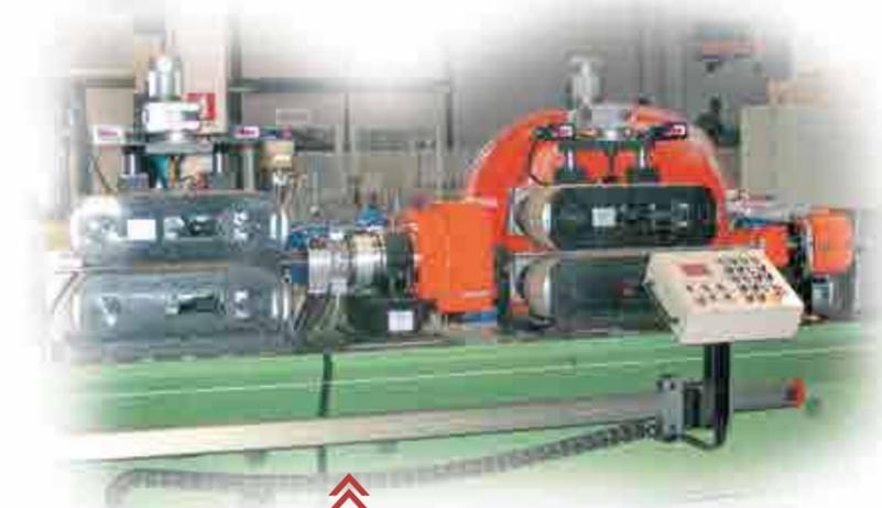
Due impianti di corrugazione in linea permettono di migliorare la profondità dell'onda garantendo un'ottima finitura.
