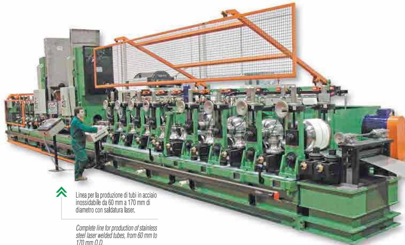
» Linea per la produzione di tubi in acciaio inossidabile da 60 mm a 170 mm di diametro con saldatura laser.
