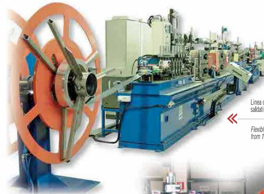
Linea di produzione Mod. 50/60 per tubi flessibili saldati da 10 mm a 60 mm di diametro.
