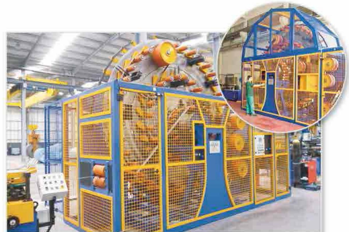
Diversi modelli di **IMPIANTI DI ACCUMULO VERTICALE** o **ORIZZONTALE** possono essere installati in linea a seconda del tipo di materiale e delle dimensioni dei tubi prodotti.
