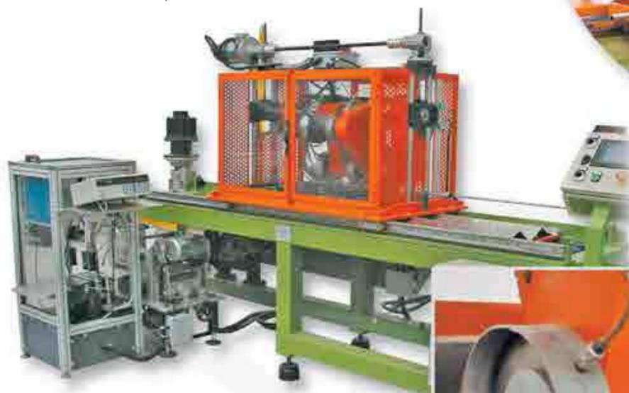
Impianto di **TAGLIO A TRE LAME** per tubi di piccole dimensioni, completo di sistema di sbavatura automatica.
