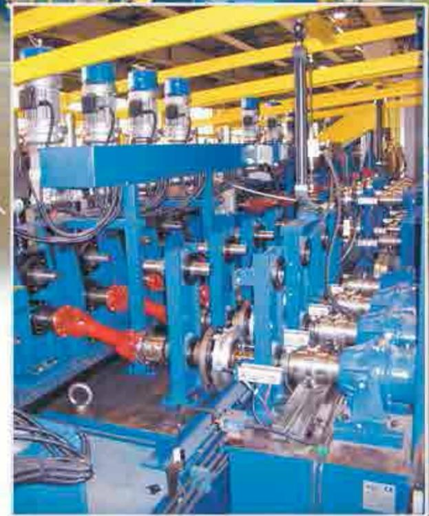
Linea per la produzione di tubi inox saldati in alta frequenza, completa con cambio rapido delle attrezzature tramite bancali intercambiabili montati su rotaie.
