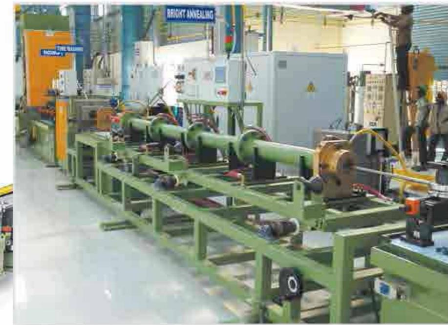
Olimpia 80 può inserire sulle proprie linee **IMPIANTI DI RICOTTURA IN ATMOSFERA CONTROLLATA**, con gamme di lavoro da 6 mm a 114 mm di diametro. Inoltre l'azienda offre soluzioni complete che comprendono unità di lavaggio del tubo e pinch roll di traino.
