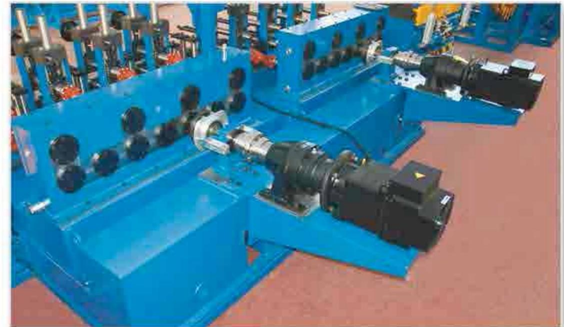
Olimpia 80 offre la possibilità di scelta tra una **MOTORIZZAZIONE STANDARD TRADIZIONALE**, composta da due motori nel gruppo di formatura e un motore nel gruppo di calibratura, oppure una **MOTORIZZAZIONE INDIVIDUALE** con un singolo motore per ogni testa motorizzata sia nel gruppo di formatura che nel gruppo di calibratura, permettendo così un maggiore controllo della lamiera ad alte velocità.
