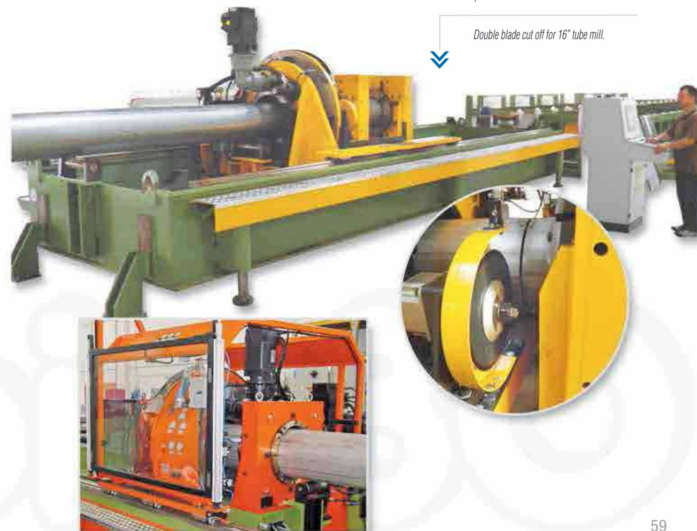
Impianto di taglio a doppia lama per linea di produzione tubi fino a 406 mm di diametro.
