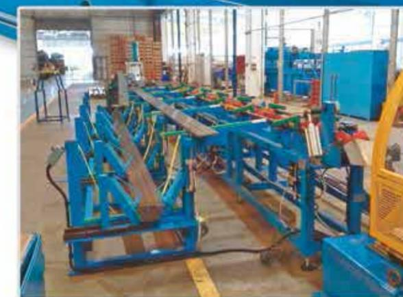
Il cordone di saldatura ottenuto con sistemi laser richiede opportuni impianti per la sua rimozione sia interna che esterna, come il nuovo **SCORDONATORE LAMELLARE** e l'innovativo **LAMINATOIO MAGNETICO**.
