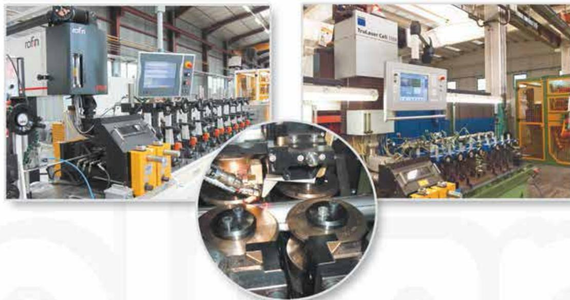
**BOX DI SALDATURA CON RULLI** per impianti laser, completi di chiusura autocentrante tramite martinetto, indicatore meccanico di posizionamento dei rulli e **cella di carico** per la rilevazione della pressione dei rulli sui lembi del tubo. Olimpia 80 offre anche la possibilità di installare, sulla stessa linea, sistemi di saldatura **TIG** e **LASER** combinati.
