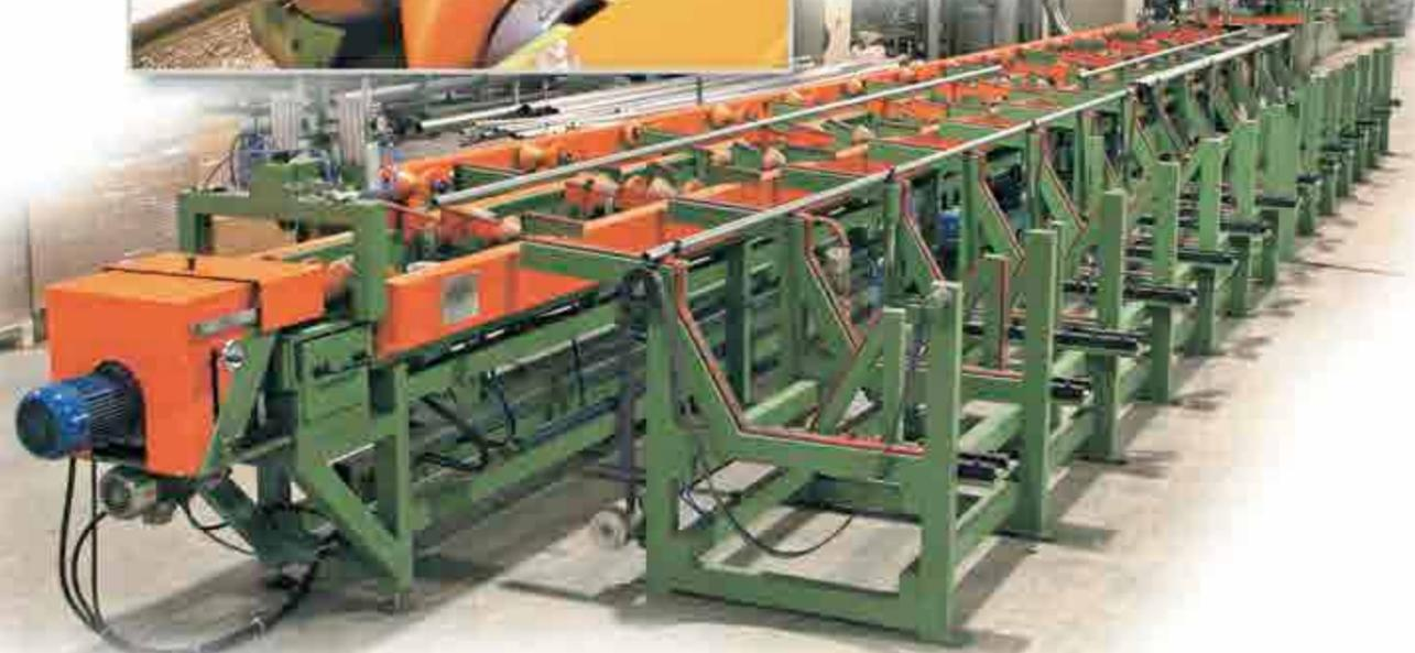
« Bancale di scarico con impianto di sbavatura ad utensili incorporato.
