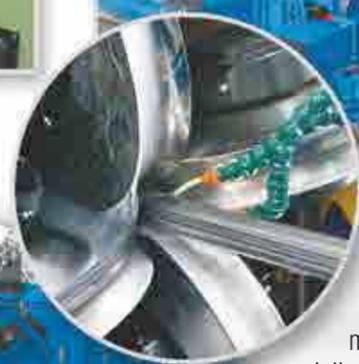
Con le nostre **TESTE di TURCO UNIVERSALI** motorizzate, si può produrre tutta la gamma di sezioni quadre e rettangolari senza cambiare alcun rullo nelle gabbie di raddrizzatura.
