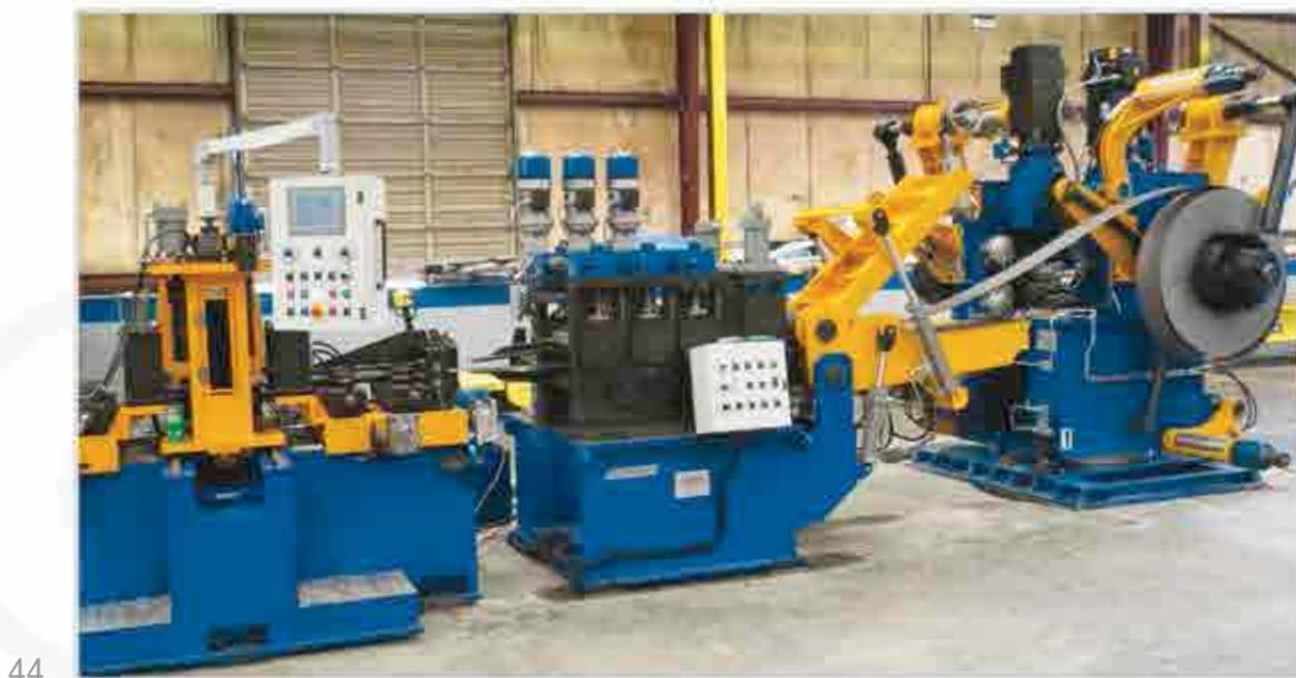
**BANCO DI GIUNZIONE** del nastro completo di taglierina idraulica, bloccaggio idraulico dei nastri, saldatura Tig automatica montata su slitta, pinch rolls di avanzamento lamiera.
