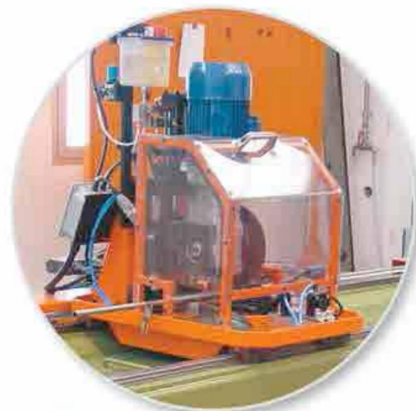
Impianto di **TAGLIO A FRESA LENTA** per tubi fino a 88.9 mm di diametro.
