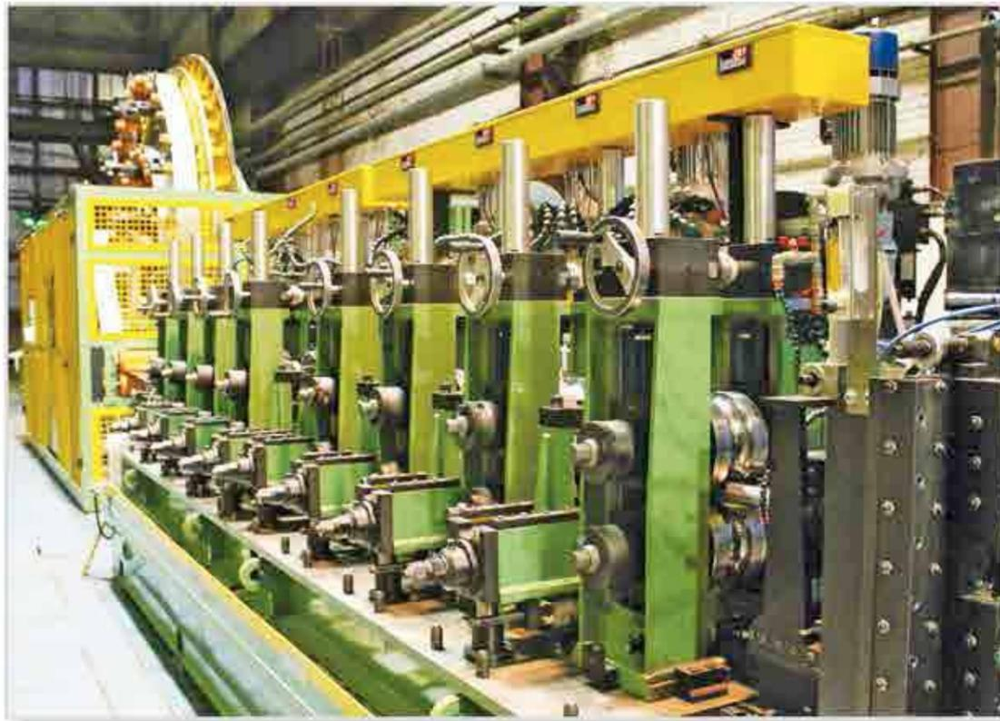
Linea per la produzione di tubi in acciaio al carbonio saldati in H.F. con diametri da 18 mm a 76 mm.
