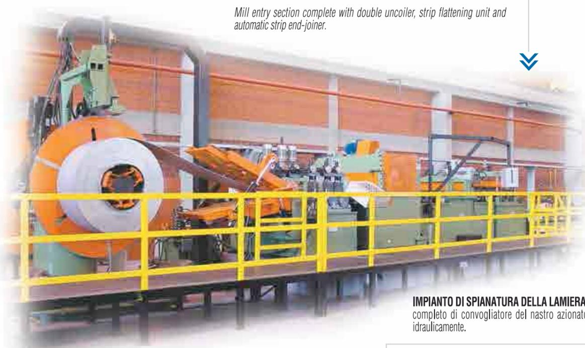
**IMPIANTO DI SPIANATURA DELLA LAMIERA**, completo di convogliatore del nastro azionato idraulicamente.
