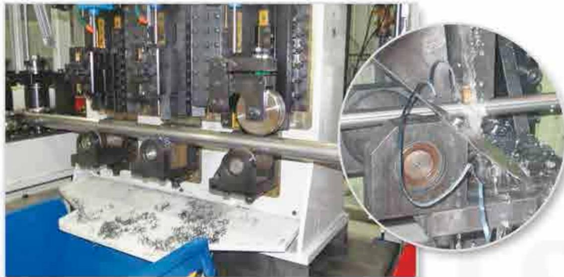
La rimozione del cordone esterno di saldatura viene eseguita tramite un **IMPIANTO DI SCORDATURA AD UTENSILI** che prevede l'utilizzo di due utensili in metallo duro regolati elettronicamente.
