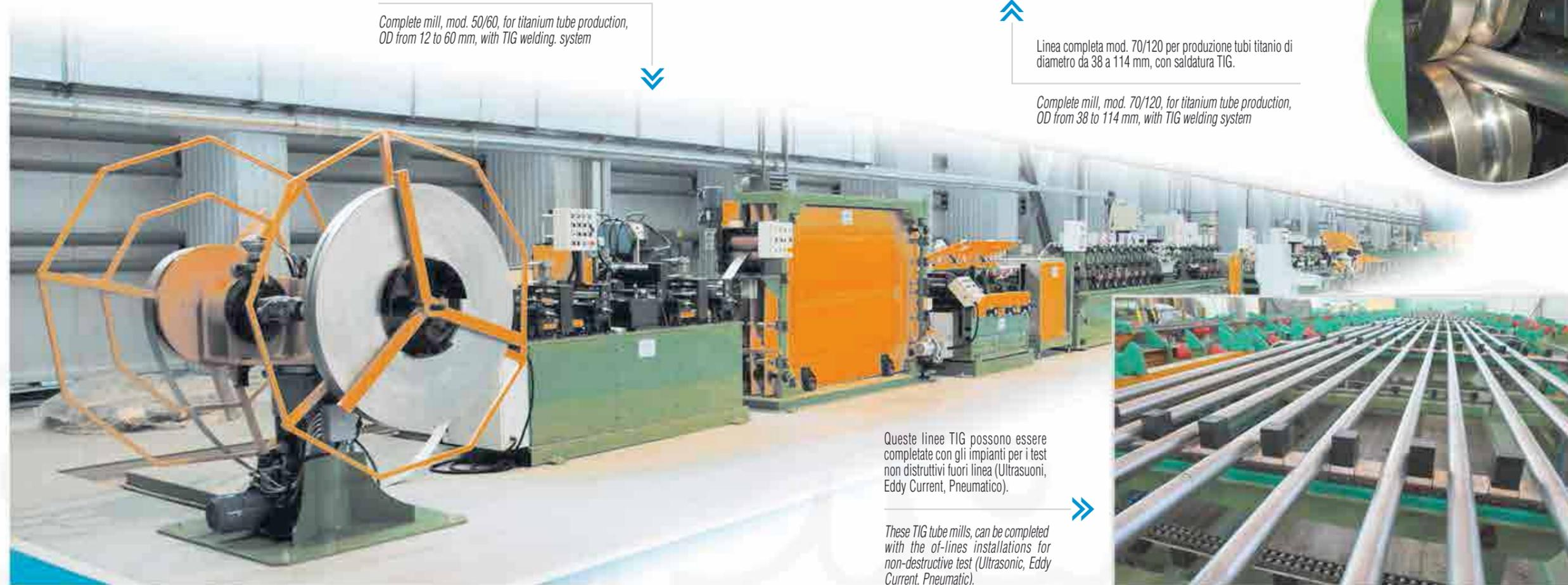
*Queste linee TIG possono essere completate con gli impianti per i test non distruttivi fuori linea (Ultrasuoni, Eddy Current, Pneumatic).*
