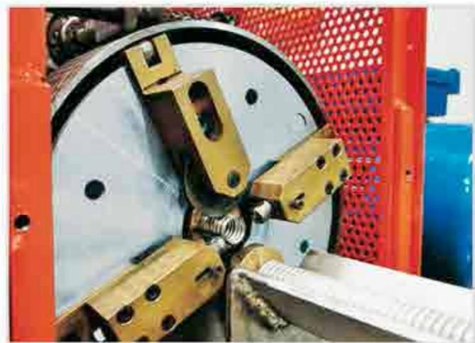
Impianto di **TAGLIO A RULLINI** per tubi sottili fino a 35 mm di diametro.
