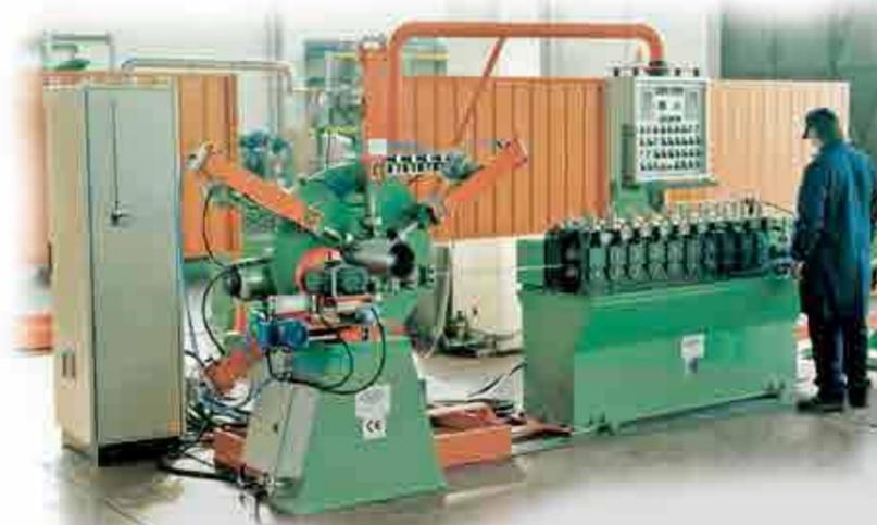
Un nuovo metodo studiato e brevettato da Olimpia 80 permette di sostituire la tradizionale aggraffatura con la saldatura a spirale del tubo per ottenere migliori prestazioni e maggiore tenuta di pressione.
