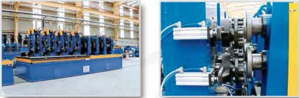
Стан для производства нержавеющей труб методом высокочастотной сварки с системой быстрой смены инструмента с помощью платформ на рельсах.
