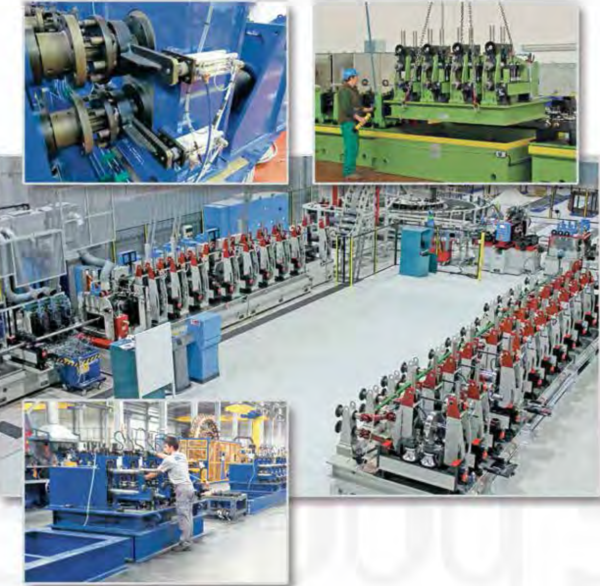
Перемещение платформы узла калибровки для осуществления смены инструмента для другого размера трубы.
