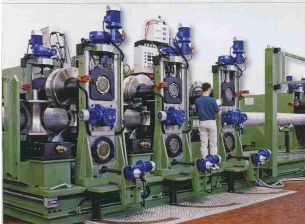
Linea Olimpia 80 per tubi in acciaio inossidabile fino a 609 mm di diametro.
