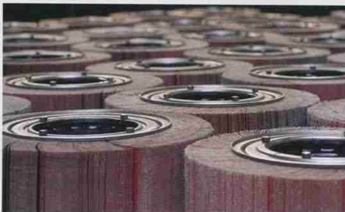
L'utensile Toolflex permette di satinare, realizzare finiture Scotch Brite , lucidature in super mirror e mantenere le finiture H9.
