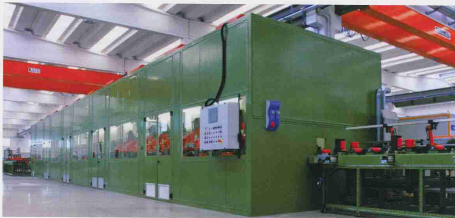
Impianto realizzato da Olimpia Surface per la satinatura con ruote lamellari abrasive.
