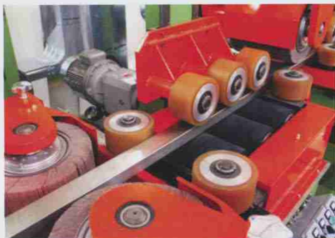
L'impianto di Olimpia Surface è ideale per satinare e lucidare tubi quadrati e rettangolari con una gamma dimensionale da 15 x 15 a 250 x 250 mm.
