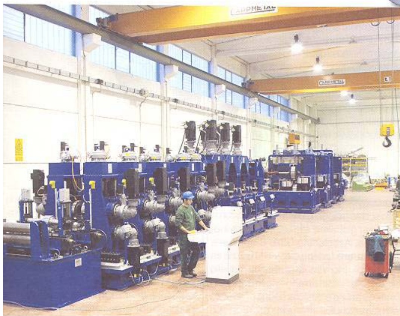
La linea di produzione a geometria lineare variabile per tubi quadri e rettangoli realizzata da Olimpia 80.
