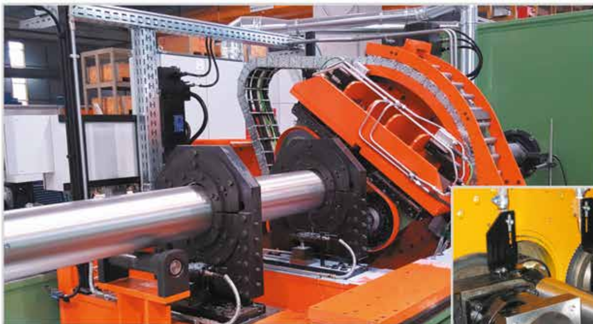
Impianto di taglio a doppia lama per tubi di grandi diametri.
