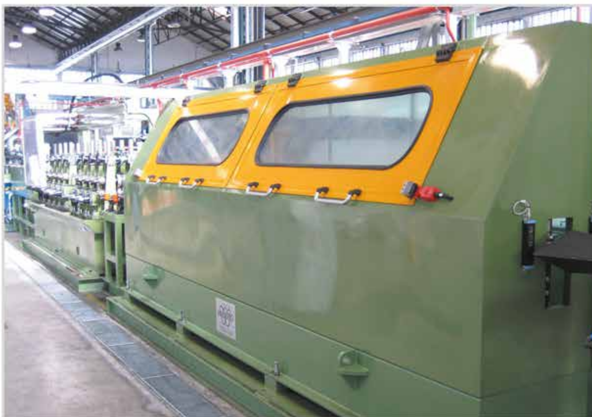
Impianto di taglio volante a disco abrasivo.
