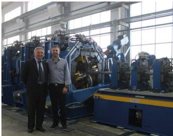
*A sinistra: linea completamente automatica per la produzione di tubi con sezioni quadrato e rettangolo (da 80x80 mm a 200x200 mm, nella gamma di spessori da 2 a 10 mm. Non è richiesto alcun cambio di rulli lungo l'intera linea. Gli assi controllati sono 74. Installata in India nel 2019*
