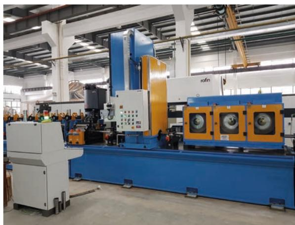
A sinistra: sezione di formatura automatica senza cambio di rulli per la produzione di tubi tondi (con diametro da 30 a 88,9 mm e spessori fino a 3,5 mm); gli assi controllati elettronicamente sono 96
