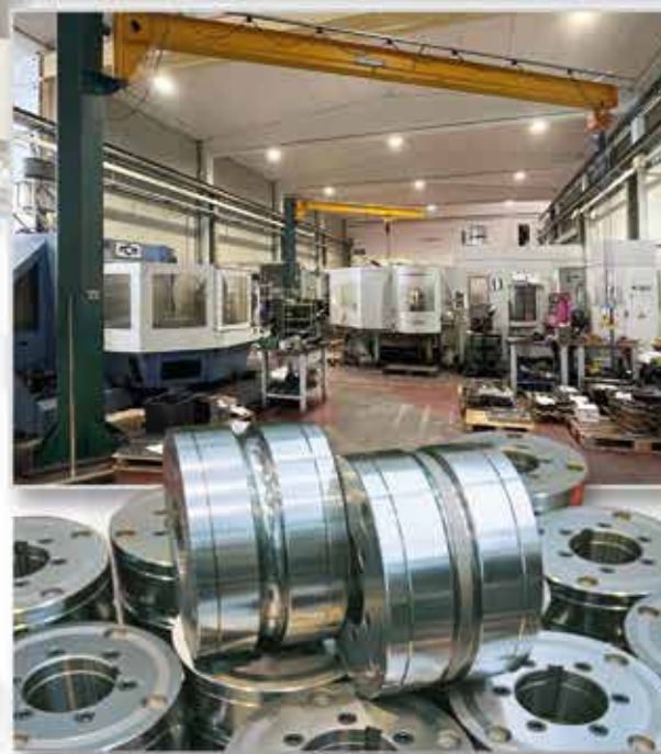
Rulli speciali a flange folli realizzati per la produzione di tubi ad alte velocità.
