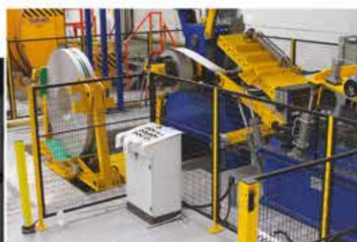
UNITA' DI RADDRIZZATURA CON BOCCA DI INSERIMENTO NASTRO AZIONATA IDRAULICAMENTE.
