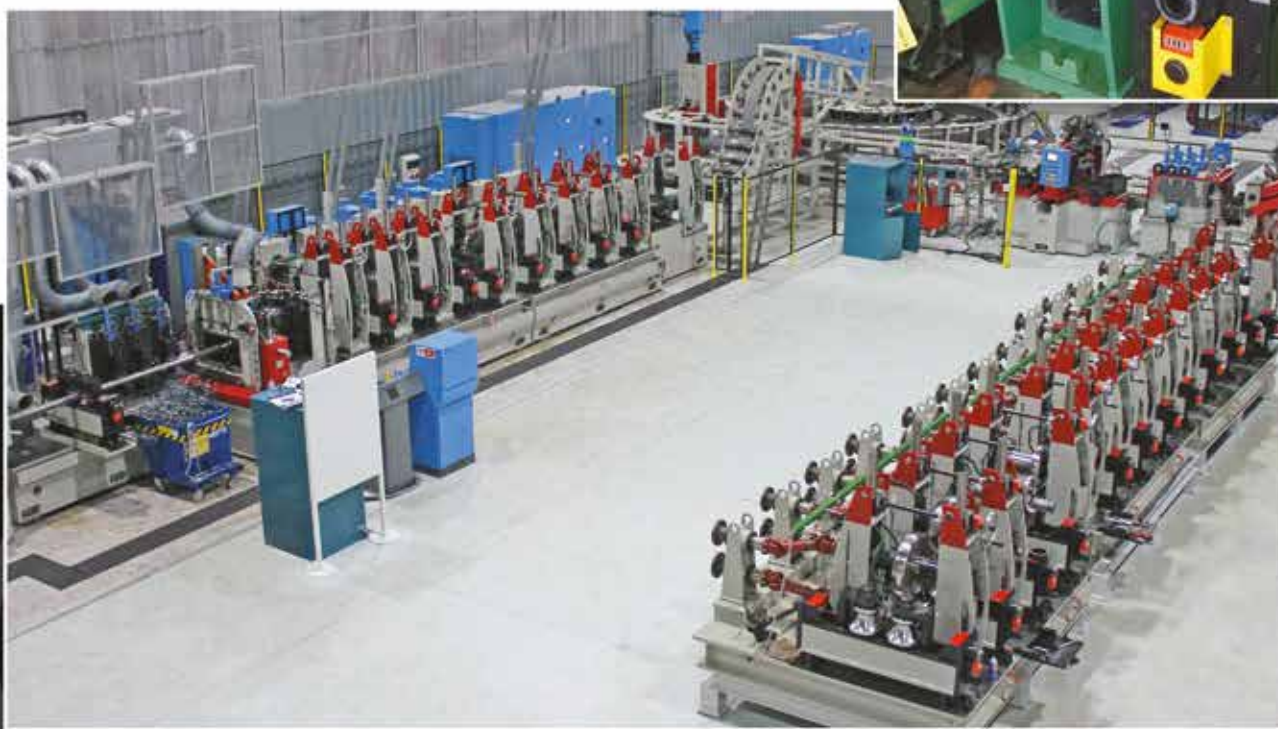
Linea per la produzione di tubi in acciaio da 35 mm a 130 mm di diametro completa di sistema di cambio rapido su bancali mobili.
