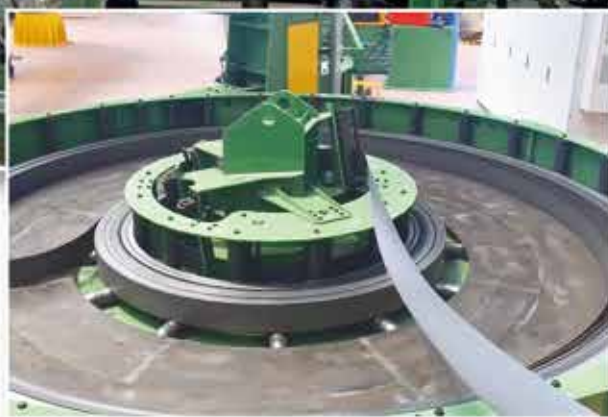
Accumulatore orizzontale con tavola rotante.
