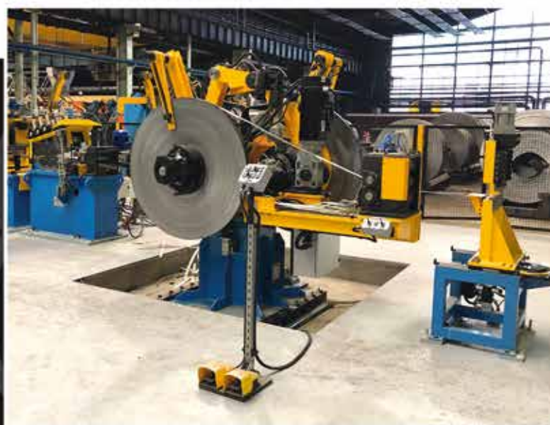
UNITA' DI RADDRIZZATURA CON BOCCA DI INSERIMENTO NASTRO AZIONATA IDRAULICAMENTE.
