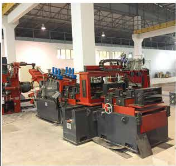
Ingresso linea con aspo doppio, con aprirotolo con raddrizzatrice e giunta nastri automatica.
