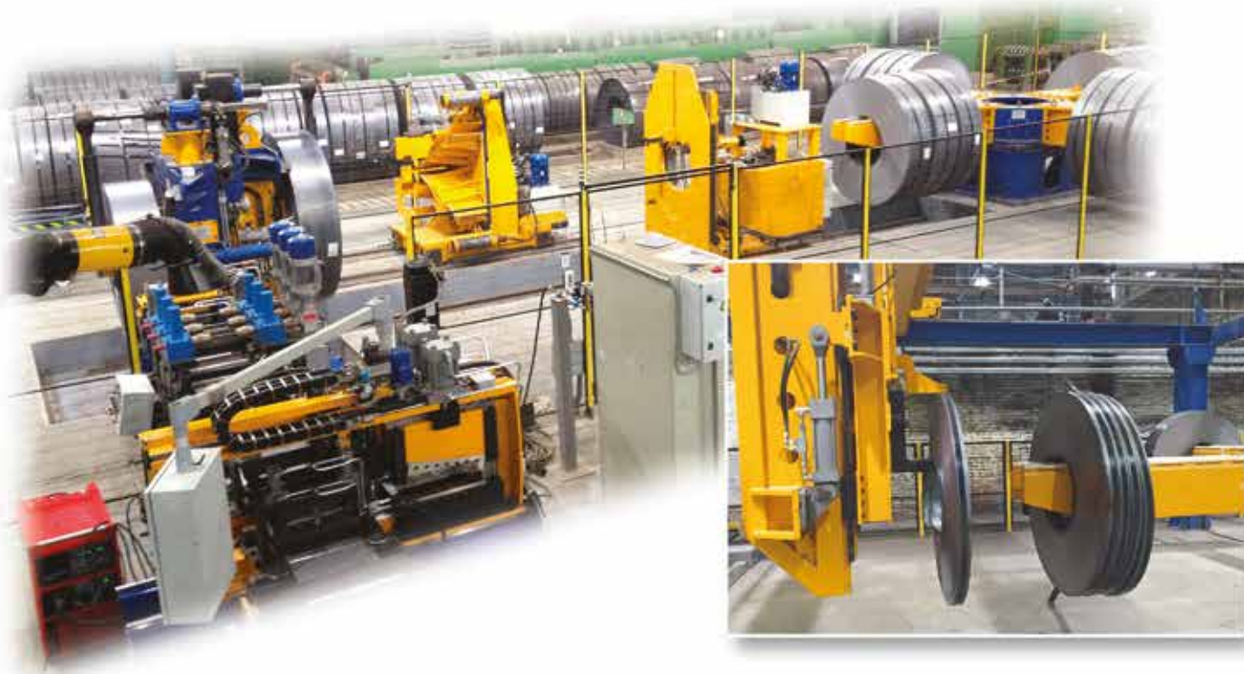
Sistema automatico di carico nastri, con giostra a 4 bracci da 120 t tot., carro di carico automatico ed aspo doppio da 9 t+9 t.
