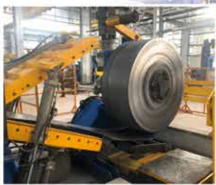
Aspo singolo da 12 t, con carro di carico con bracci di contenimento laterali. Installato su linee da 8" e 10".
