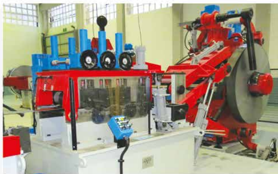
Aspo doppio da 9+9 t, con aprirotolo e raddrizzatrice.
