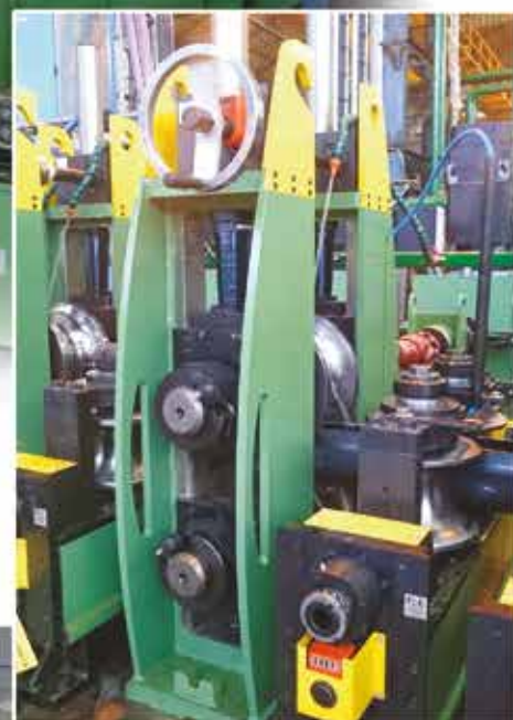
Linea per la produzione di tubi in acciaio da 30 mm a 127 mm di diametro completa di sistema di cambio rapido su bancali mobili.
