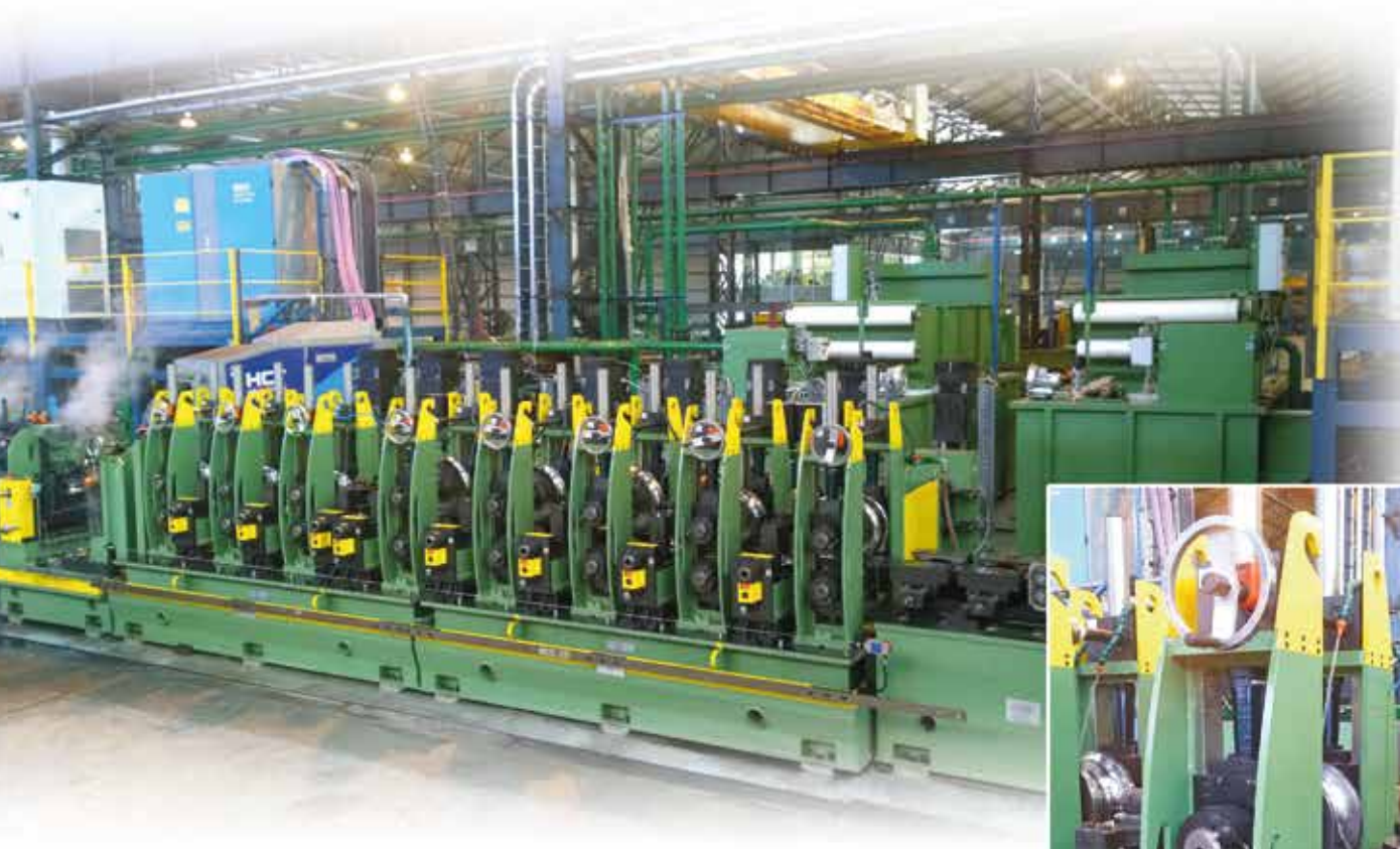
Linea per la produzione di tubi in acciaio da 30 mm a 127 mm di diametro completa di sistema di cambio rapido su bancali mobili.
