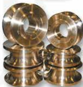
Rulli speciali a flange folli realizzati per la produzione di tubi ad alte velocità.
