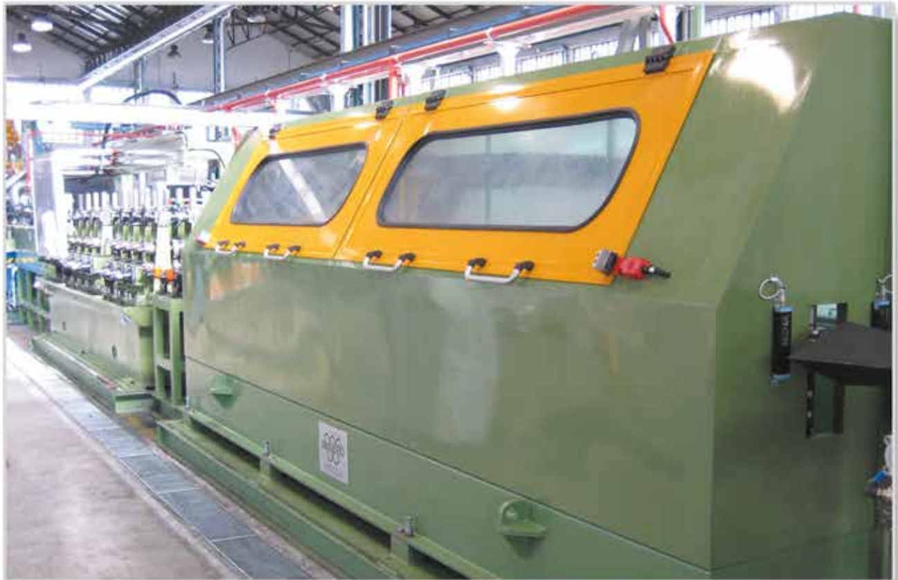
Impianto di taglio volante a disco abrasivo.
