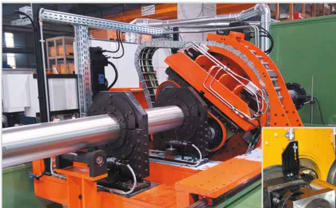
Impianto di taglio a doppia lama per tubi di grandi diametri.
