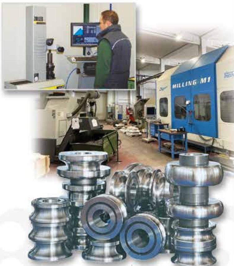
Rulli per la produzione di tubi tondi realizzati in acciaio DIN 1.2379, 62 HRC.
